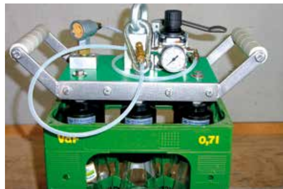
Ручная упаковочная головка на 6 бутылок для фруктовых соков 0,7 л
