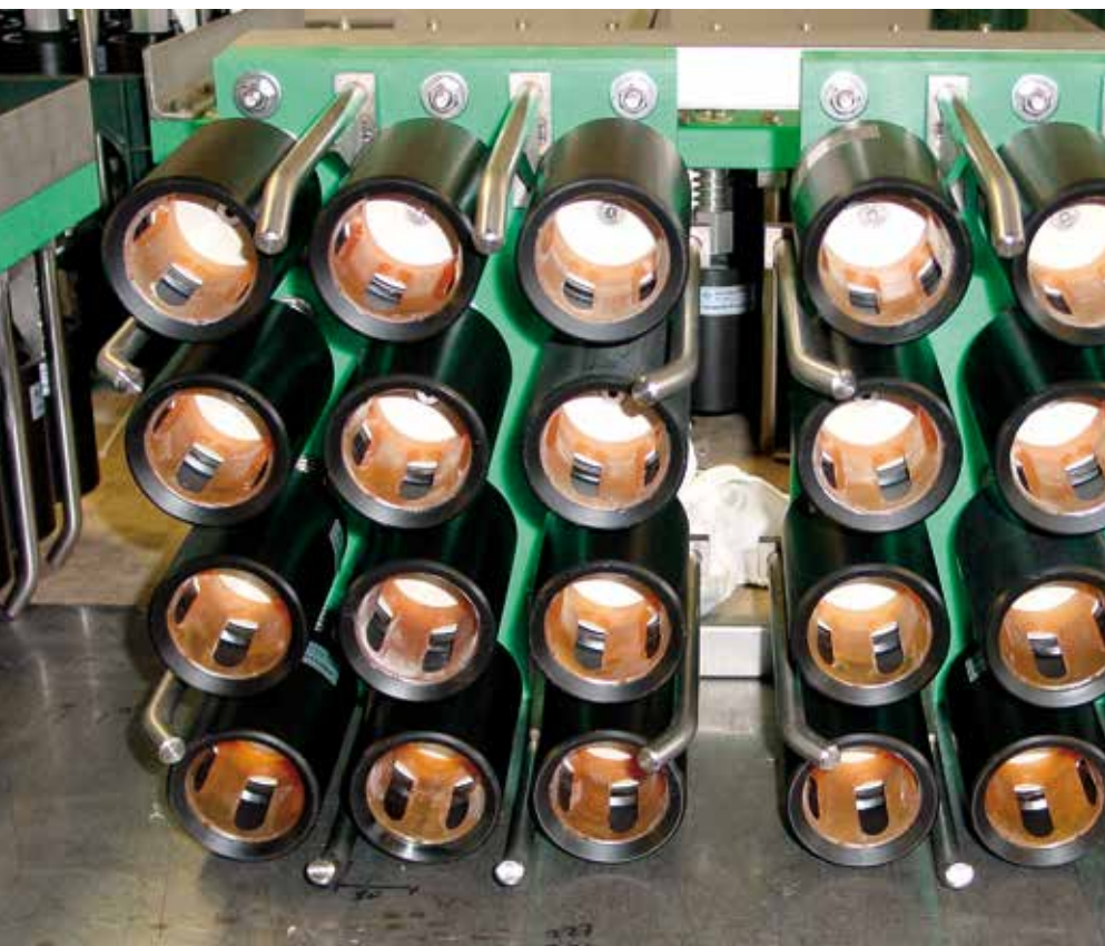
Специальная ручная упаковочная головка для переупаковки 2 блоков из 6 бутылок в универсальный ящик
