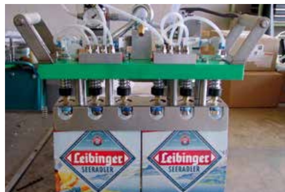
Специальная ручная упаковочная головка для переупаковки 2 блоков из 6 бутылок в универсальный ящик
