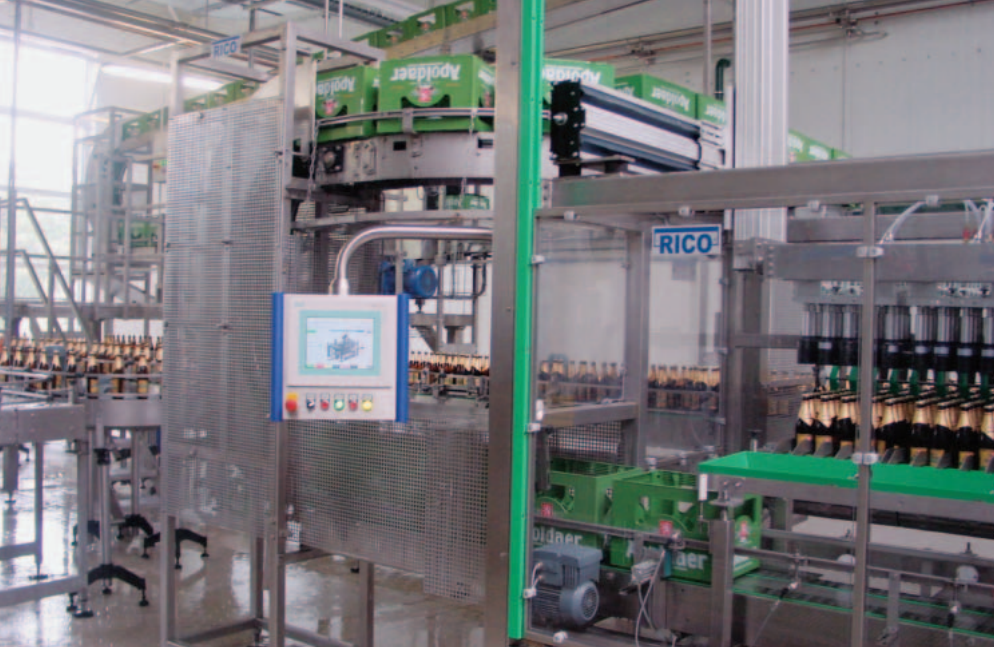
Von der Kastenwaschanlage werden die Kästen in lockerem Abstand durch den zweiten C-Wender zum Einpacker geführt.
