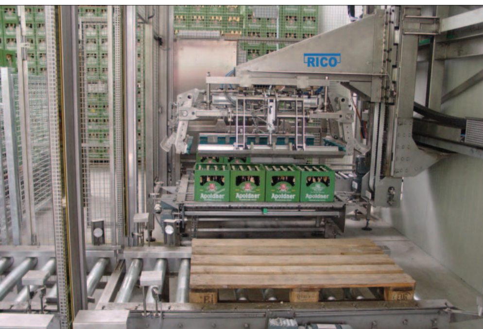
Lagenbildung mittels Winkelübergabe auf einer angetriebenen Rollbahn. Die fertige Lage wird vom Greifer abgenommen und auf einer Palette abgesetzt.
