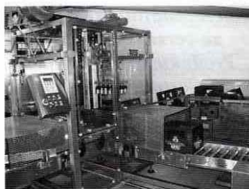
Abb. 4 Im Auspacker entnimmt der Greiferkopf die leeren Flaschen aus den 20er- bzw. 24er-Kästen
