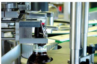
**Die Aufdrückstation** öffnet den Bügel. Der Druck ist regelbar und die Schieber sind kurvengesteuert.
