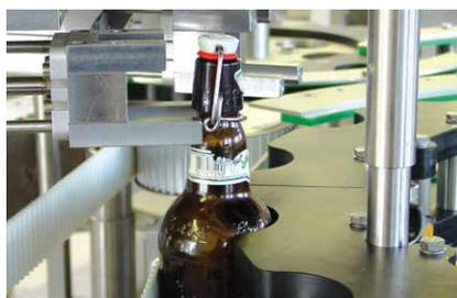
**Die Ausrichtstation** senkt sich auf den verschlossenen Bügel ab, die Ausrichtkappe rastet ein und dreht die Flasche in Öffnungsposition.
