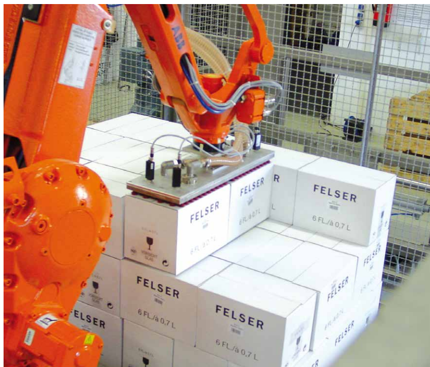
Palettierroboter mit Vakuum-Sauggreifern
