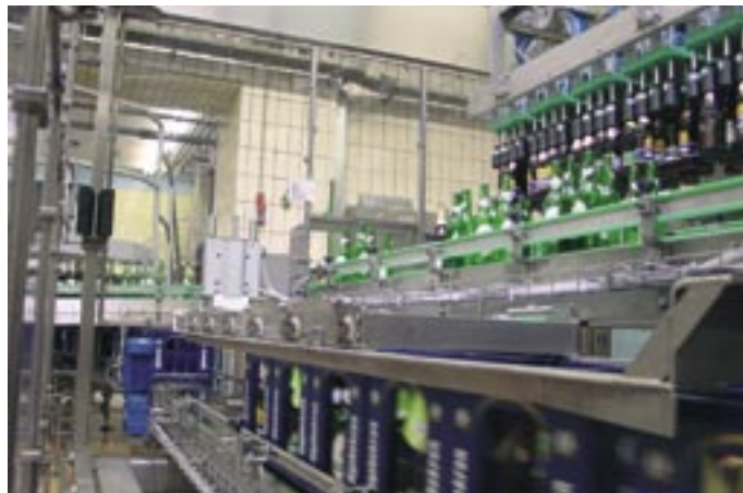
Platz- und kosteneffizient sorgt der Selektiv-Auspacker VARI für die schnelle Flaschenzufuhr bei der Landskron Brauerei Görlitz
