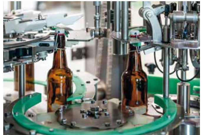
Der kontinuierliche Verschließvorgang mit mechanisch geführten, fließenden Bewegungsabläufen ermöglicht verschleißarme, beste Verschleißleistungen.
