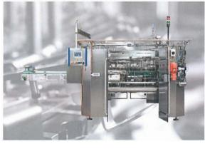
Darüber hinaus bietet Rico auch Gummi-Wechsler verschiedener Leistungsstufen zum automatisierten Dichtgummiwechsel an Bügelflaschen an.
