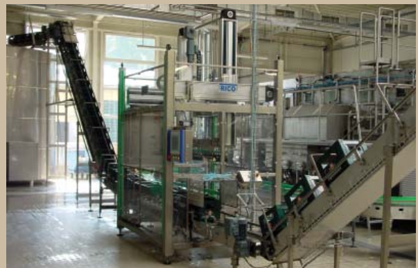
Abb. 2 Die platz sparende und wartungsarme Auspackmaschine Vari 3-Kopf
